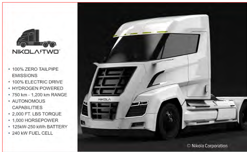
Mynd 32. Flutningabifreið sem gengur fyrir vetni og notar efnarafal. Mynd: Jacob Krogsgards, 2018.
