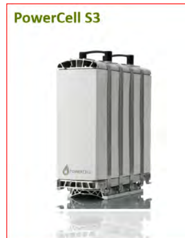
Mynd 33. Efnarafall, hámarks- afköst 125 kW., stærð 419 x 156 x 568 mm. Mynd af vef PowerCell AB í Svíþjóð.
