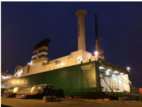
Mynd 37. Vindorka beisluð til að knýja áfram finnska gámaskipið Estraden. Mynd af MarineInsight vefnum, upphafl. NAPA (The Nordic Institute in Greenland).
